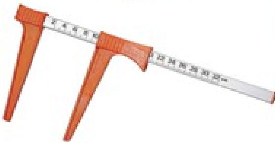
**Мерная вилка**—прибор для измерения диаметра ствола дерева.
